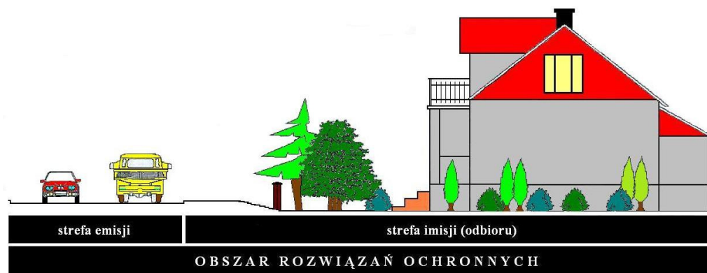
Ryc. 16 Strefy emisji i imisji hałasu oraz obszar rozwiązań ochronnych w uniwersalnym podejściu do ochrony przed hałasem drogowym 37
