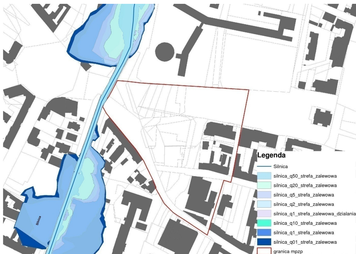
Ryc.15 Projekt planu na tle stref zalewowych rzeki Silnicy na podstawie „Wykonanie koncepcji ochrony przeciwpowodziowej w zlewni Bobrzy, Silnicy, Sufragańca i Lubrzanki na obszarze miasta Kielce” 24 .
