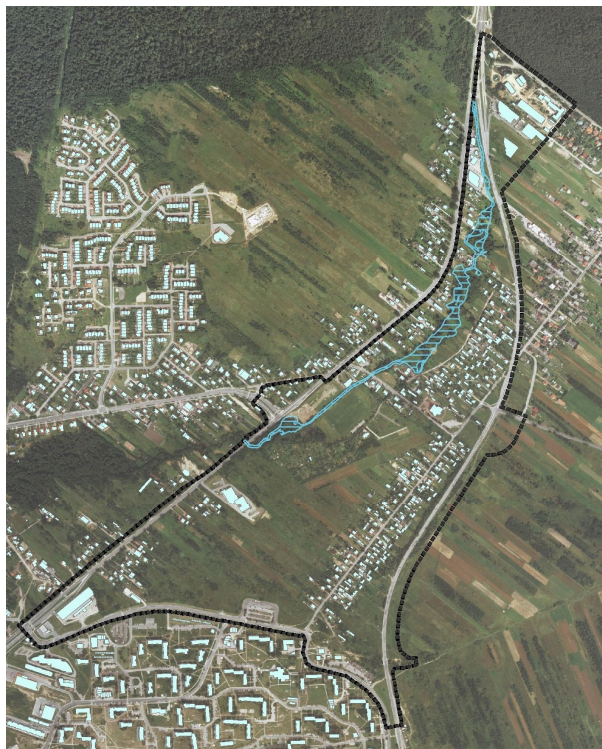
Rys. 5. Zasięg stuletnich (Q1%) wód powodziowych Silnicy.
